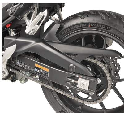
KMG1203 Spezifische Hinterradabdeckung aus ABS, schwarz
